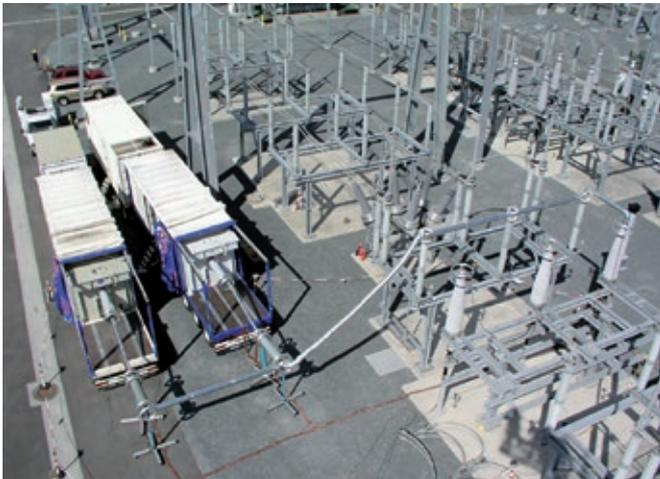
Abb. 3 Vor-Ort-Prüfung an Kabel mit HiRES Locator und Wechselspannungs-Resonanzprüfsystem WRV 83/260 T
