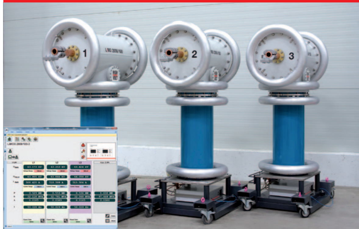
Fig. 1 LiMOS 2000/100 formado por tres sensores con unidades máximas de transferencia (MTU) y la pantalla remota
