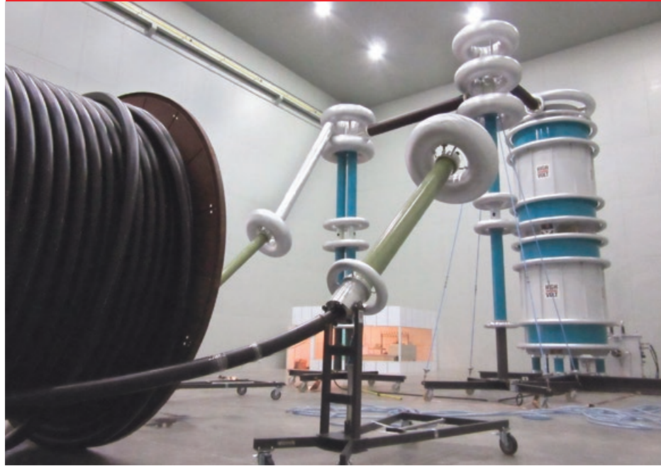
Abb. 1 Wassergefüllte Prüfendverschlüsse, Typ CET
