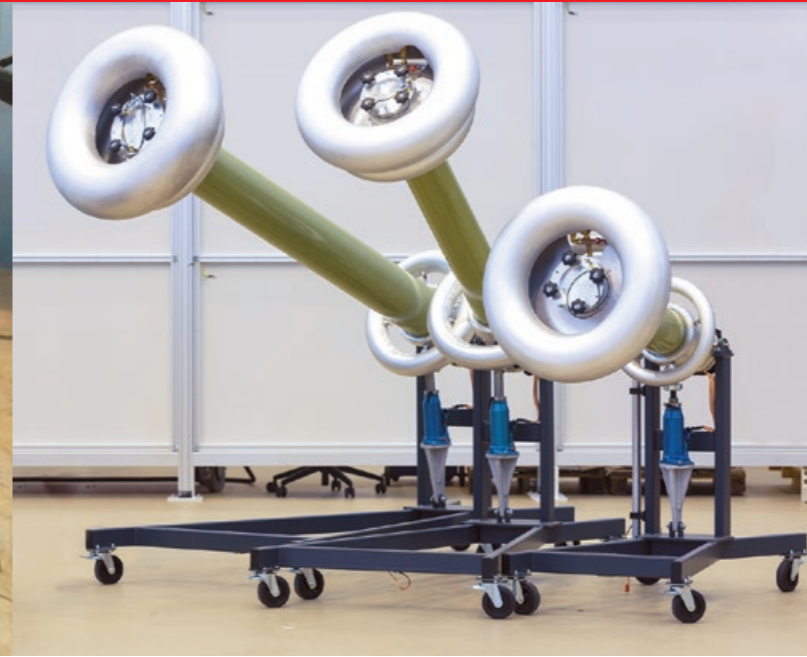
Abb. 3 Wassergefüllte Prüfendverschlüsse, Typ CET, verschiedene Nennspannungen
