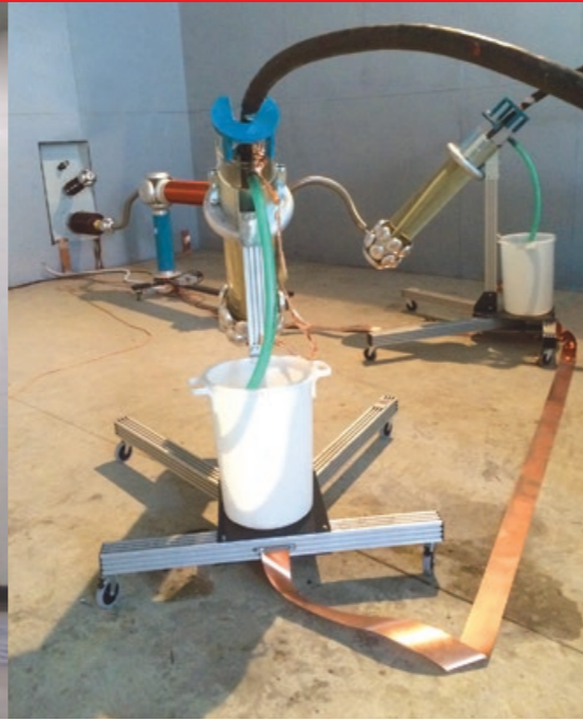
Abb. 2 Ölgefüllte Prüfendverschlüsse, Typ EKP
