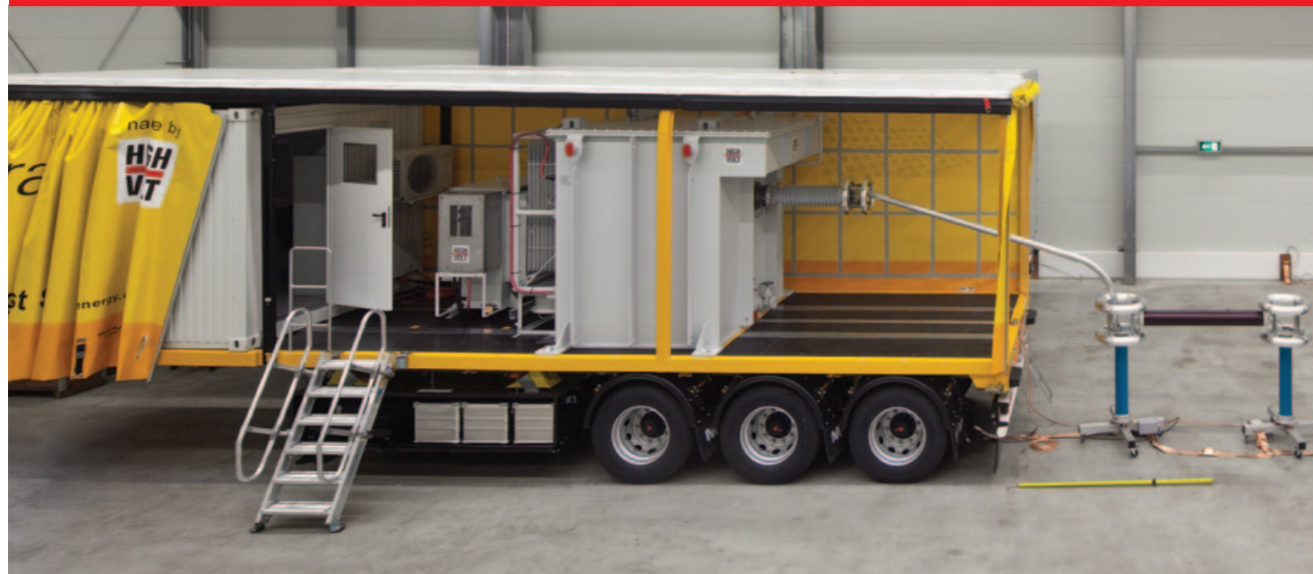
Fig. 1 Système d'essai résonant AC de câbles haute tension extrudés pour un essai sur site, type WRV 90/150 T
