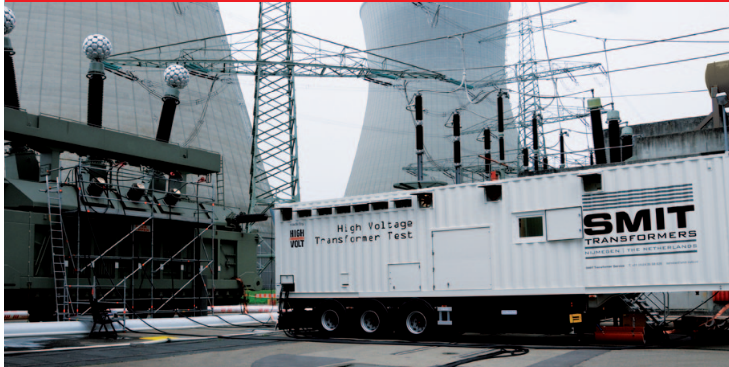
Fig. 1 Ensayo in situ de una unidad de 1100 MVA en una central nuclear
