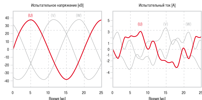
Рис. 4 Форма испытательных напряжения и тока – измерение потерь без нагрузки при 100 % с THDu < 3,2 % и THDi = 43 % (трансформатор на 500 МВА)
