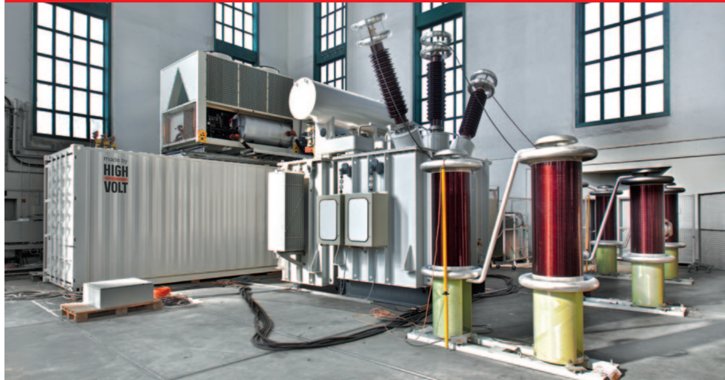
Fig. 1 Sistema padrão para testes de tensão induzida, baseado em conversor estático de frequência, tipo WV 2000-4000/170
