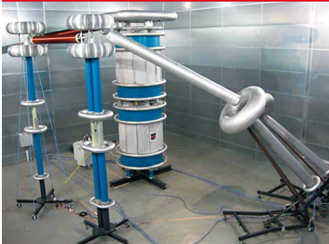
Рис. 1 Испытательный участок для кабелей на 500 кВ с системой типовых испытаний WRM на 800 кВ, 28.000 кВА
